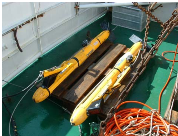
Fig. 2 : Photo des sonars DF 1000 de la société Edgetech utilisés par Ifremer/Genavir
